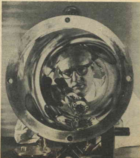
Il Dottor Harold Lyons esamina il cuore tubolare dell'orologio atomico che sarà lanciato nello spazio per controllare due teorie della relatività di Einstein.
